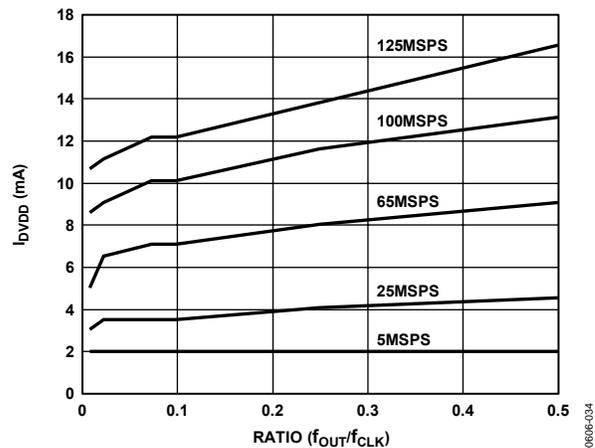
Figure 35.  $I_{DVDD}$  vs. Ratio @  $DVDD1 = DVDD2 = 3.3$  V
