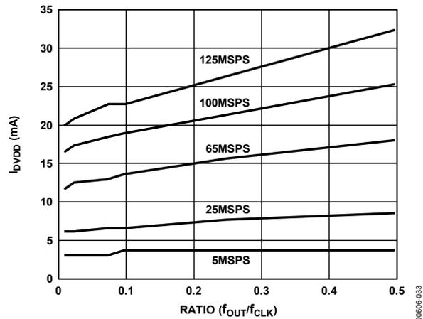
Figure 34.  $I_{DVDD}$  vs. Ratio @  $DVDD1 = DVDD2 = 5$  V
