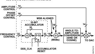
Figure 27. DDS Block Diagram
