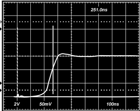
Figure 52. Rising Edge Output Settling Time
