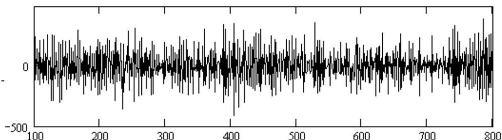
Рис. 4. Вторая производная сигнала, рассчитанная по 5-м точкам
