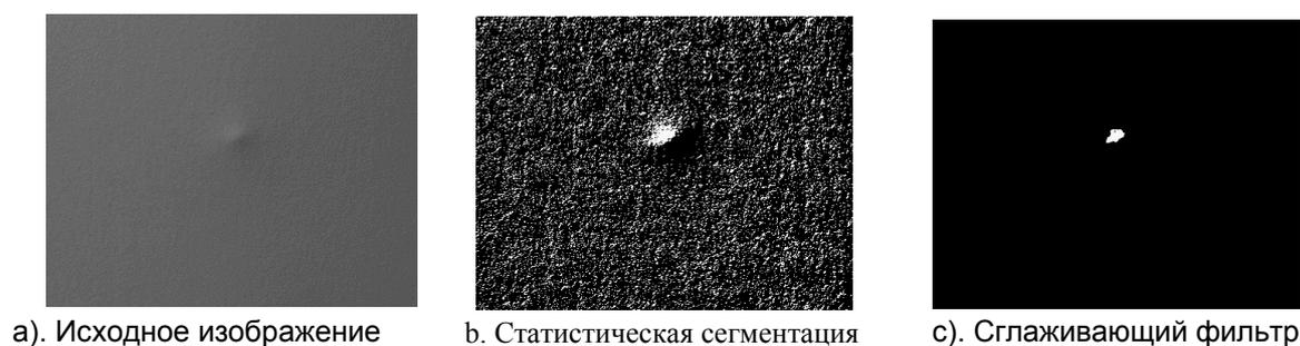
Рис.2. (Fig.2) Обнаружение дефектов поверхностей. (Surface defect detection.)
