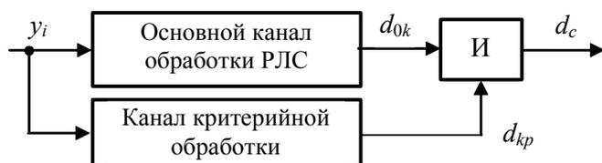
Рис. 1. Структурная схема блока обработки пачки эхо-сигналов
