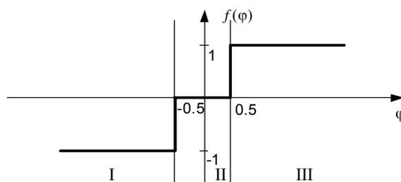
Рис. 2. Функция нелинейности сумматора с насыщением и трехуровневым квантованием
