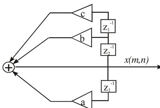
Рис. 1. Структурная схема автономного двумерного рекурсивного цифрового фильтра первого порядка
