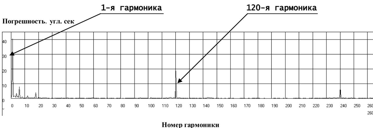
Рис. п.1.6. Спектр кинематической погрешности механизма
