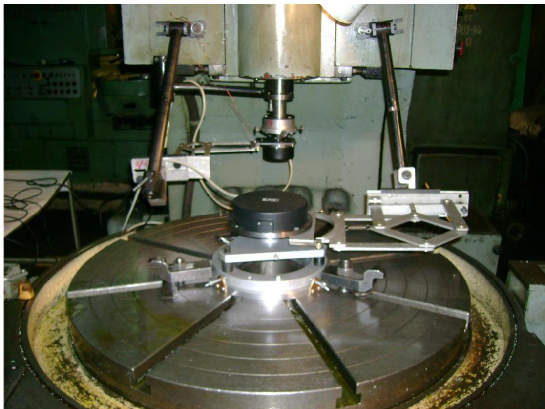
Рис. П.6.3. Проверка кинематической точности зубодолбёжного станка мод. 5М150 ПФ (вид спереди).
