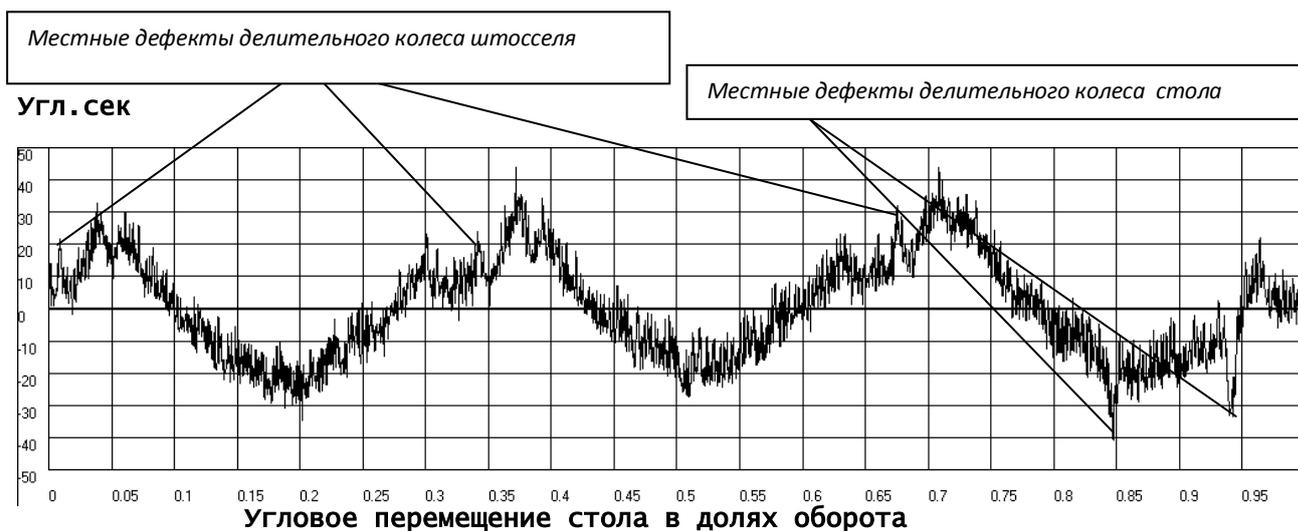
Рисунок 7.6. График временной функции кинематической погрешности
