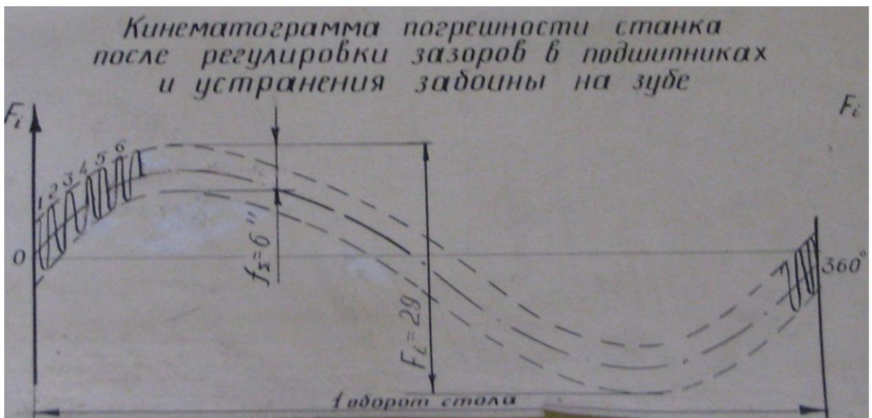
Рис.п.4.4. График кинематической погрешности станка после ремонта.
