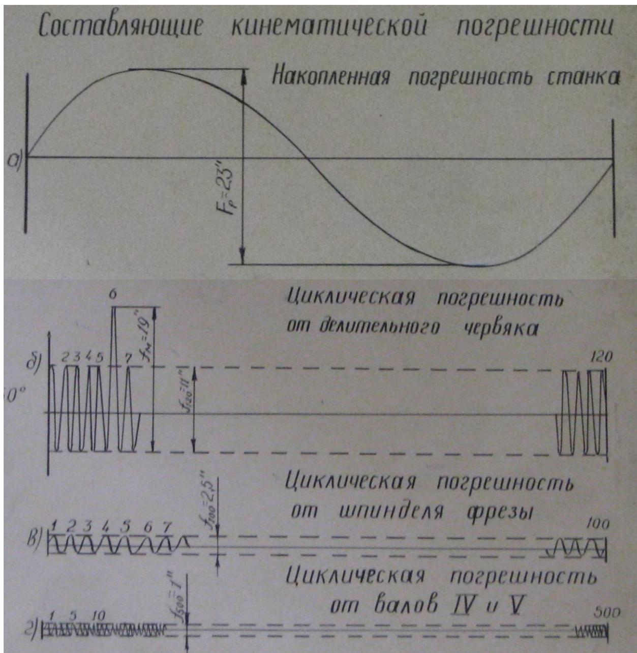
Рис. п.4.3. Графики гармонических составляющих кинематической погрешности станка мод. УРН 30 (Результаты предремонтной проверки).
