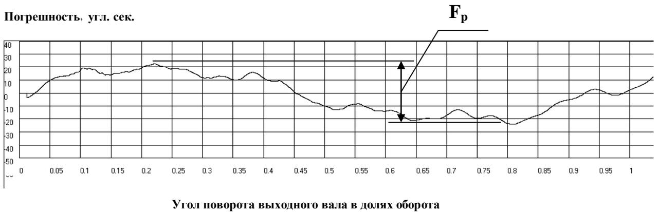
Рис. п.1.3. График временной функции накопленной погрешности механизма
