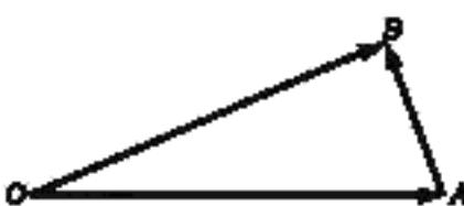
Рисунок G.1 — Векторный эффект установки пробных масс
