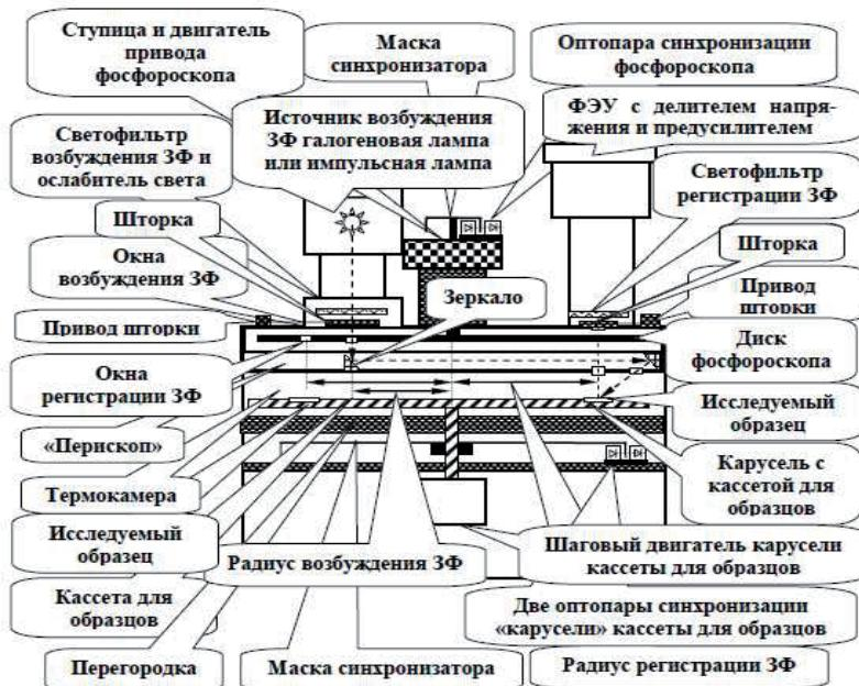
Рис. 15.2. Принципиальная схема однодисковой установки для регистрации ЗФ исследуемых образцов карусельного типа.
