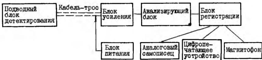
Рис. 13.4. Структурная схема подводной радиометрической аппаратуры.
