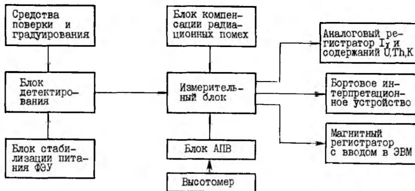
Рис. 9.2. Структурная схема аэрогамма-спектрометра.
