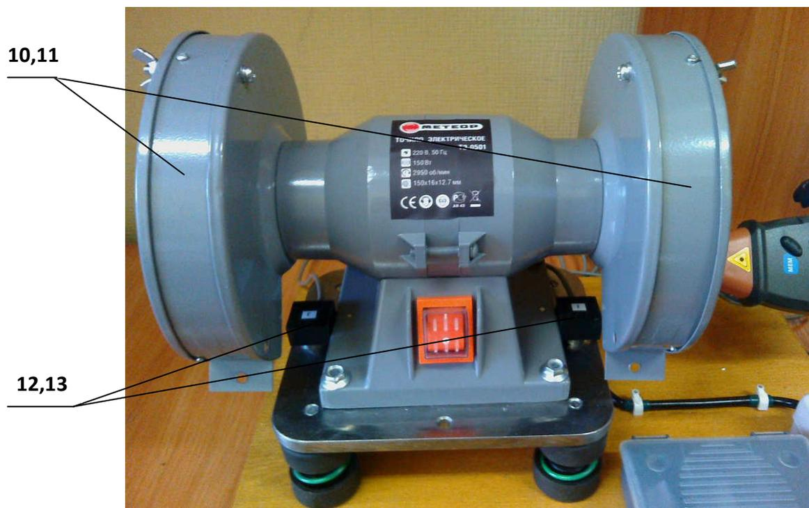
Рис. 2. Балансировочный стенд (вид спереди).
