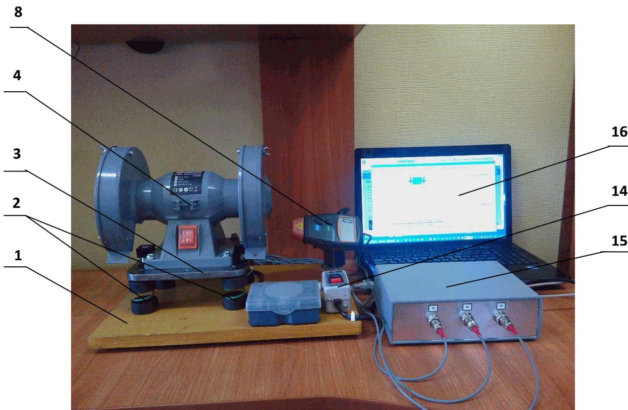
Рис. 1. Балансировочный стенд в комплекте с измерительным блоком и компьютером
