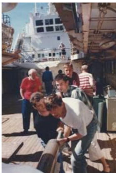
Выбивают керн из трубки.
