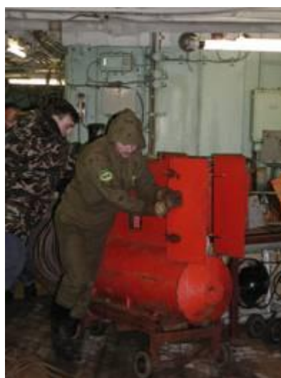
В ангаре подводных аппаратов. Заглубитель ПА МАК-1м.
