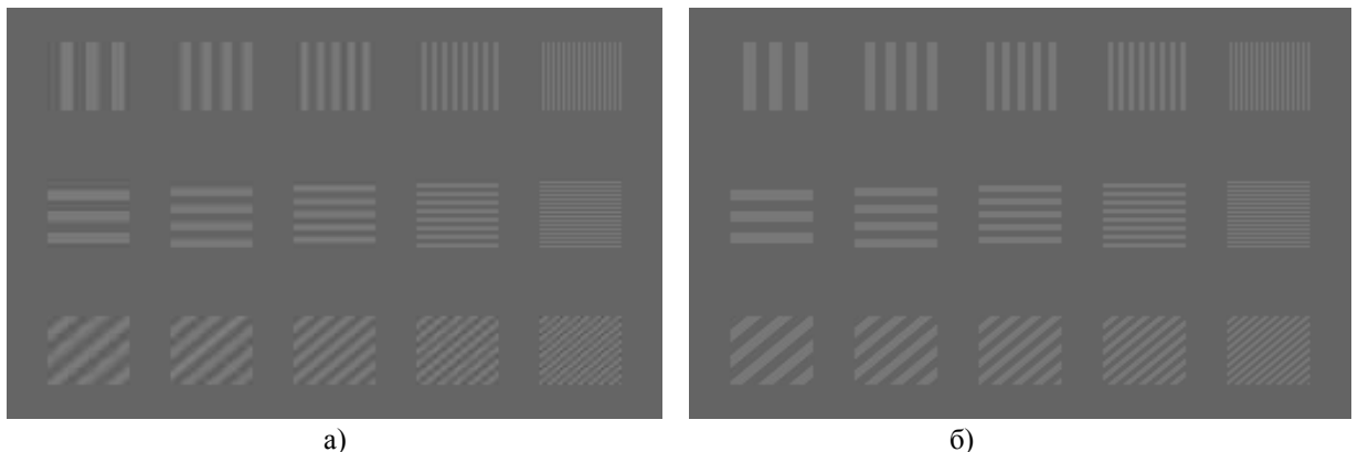
Рис. 2. Декодированные тестовые изображения: а) q=1 , сжатие - 19,5; б) q=8 , сжатие - 13,8.
