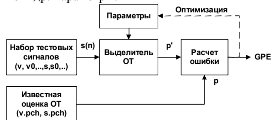
Рис. 3. Схема экспериментальной оценки помехоустойчивости выделителей ОТ.
