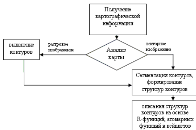
Рис. 2. Структурная схема алгоритма описания сложного контура
