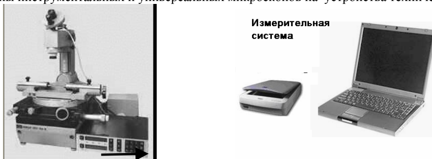
Рис.1. Вместо микроскопа измерительная система для линейно-угловых измерений.
