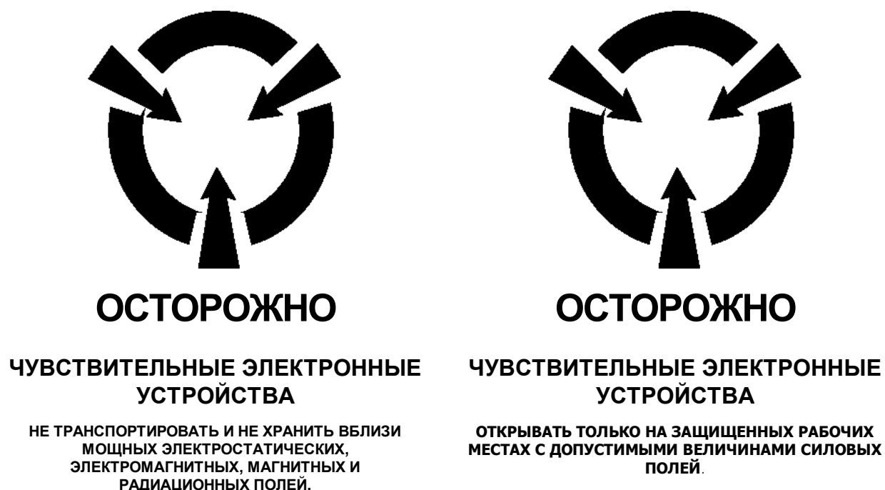
Рис. 10.61. Обозначение устройств чувствительных к электростатическому разряду.
