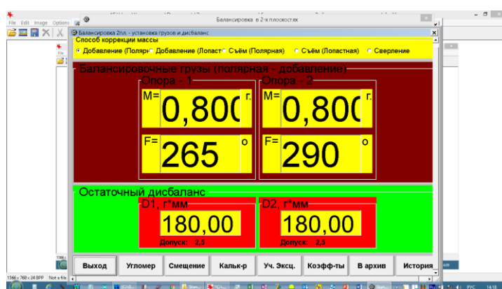
Рис. 6.3. Результаты остаточной неуравновешенности ротора, полученные после выполнения 4-го пуска
