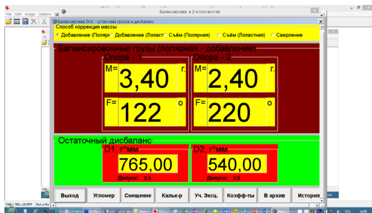
Рис. 6.2. Результаты остаточной неуравновешенности ротора, полученные после выполнения 3-го пуска
