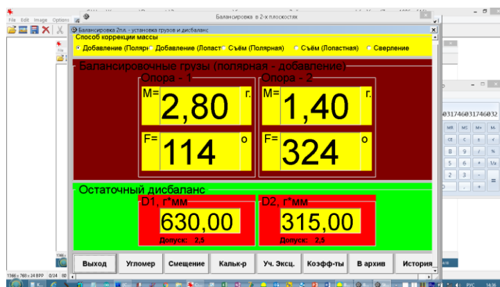
Рис. 6.4. Результаты остаточной неуравновешенности ротора, полученные после выполнения 5-го пуска (после разворота на 180^{\circ} )
