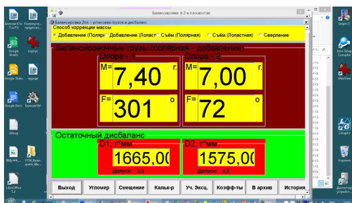
Рис. 6.1. Результаты остаточной неуравновешенности ротора, полученные после выполнения 2-го пуска
