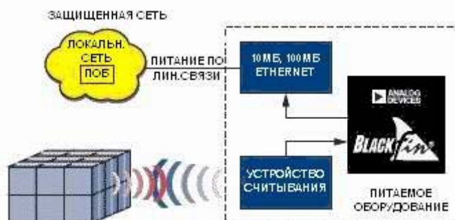
Рис. 4. Пример системы радиочастотной идентификации объектов с питанием по линии локальной связи; здесь ПОВ – питающее оборудование
