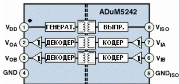
Рис. 7. Блок-схема ИС ADuM5242 двухканальной развязки с интегральным dc-dc конвертером. ИС имеет все сертификаты
